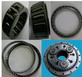
图3 RV减速器及轴承组件
